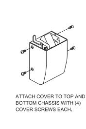
CHECK FINAL OPERATION OF DEVICE AND ADJUST , THEN FASTEN COVERS.
